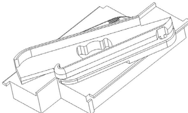
*Addirittura, senza cambiare componenti, ma semplicemente in base al modo in cui vengono assemblati i supporti lamella, possono essere realizzati teli persiana con alcune lamelle chiuse ed altre orientate.*
